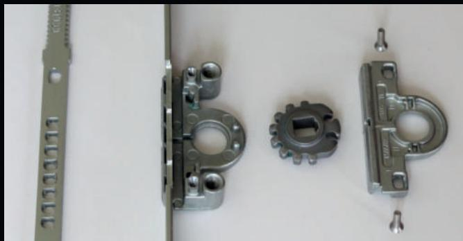
3 Das neue Schneckengehäuse mit einem passenden Schraubendreher öffnen und in seine Einzelteile zerlegen.
