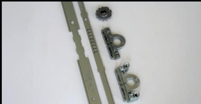
1 Altes Getriebe, Nieten mit einem 5 mm Bohrer ausbohren.
